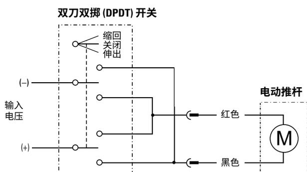
连接黑色导线到正极，红色导线到负极，电动推杆伸出。改变极性，电动推杆缩回。
