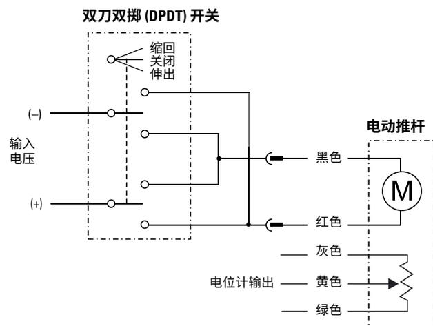
连接红色引线到正极，黑色引线到负极，电动推杆伸出。改变极性，电动推杆缩回。当电动推杆完全伸出时，电位计输出电缆灰色导线与黄色导线间的电阻必须是0 ohm。
