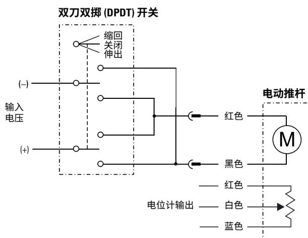
连接黑色导线到正极，红色导线到负极，电动推杆伸出。改变极性，电动推杆缩回。当电动推杆完全伸出时，电位计输出白色与红色导线间的电阻必须是0 ohm。
